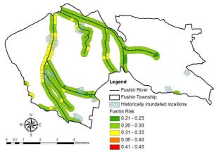
$\textbf{Fig. 12} \ \textbf{Potential} \ \textbf{of inundation} \ \textbf{caused} \ \textbf{by broken} \ \textbf{dikes} \ \textbf{in the} \ 200 \ \textbf{meter} \ \textbf{buffer} \ \textbf{of} \ \textbf{Fushin} \ \textbf{Rivers}$
